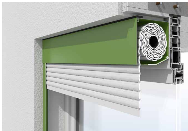
Einbausituation 20° Vorbaukasten, Revision unten, Rechtsroller in der Laibung
