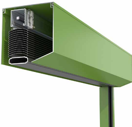
Abgeschrägt 20°, Kasten stranggepresst, Revision vorn
